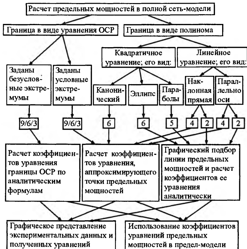
Рис. 1.5. Диаграмма вариантов получения коэффициентов уравнения описывающего границу области допустимых режимов
